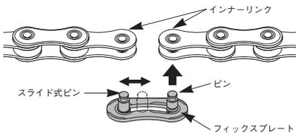
2. スライドプレートの穴にピンを差し込みます。(このときスライドプレートのくぼんでいる方が外側になるようにしてください)。次にスライドプレートを矢印の方向にスライドさせます。
