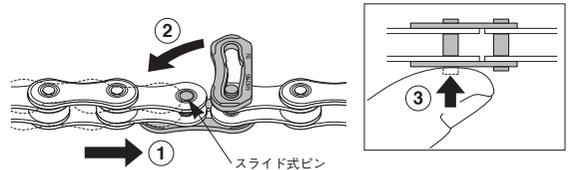
4. チェーンを矢印の方向に引っ張りながらスライド式ピンを移動させ、クイックリンクをセットします。
