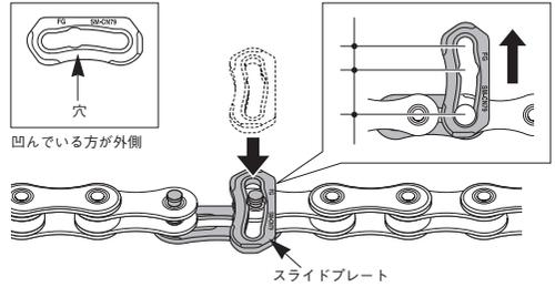
3. ①の方向にスライド式ピンを近づけ、スライドプレートを②の方向に回転させます。穴とスライド式ピンを重ね③の方向にスライド式ピンを押し上げるようにして嵌め込みます。
