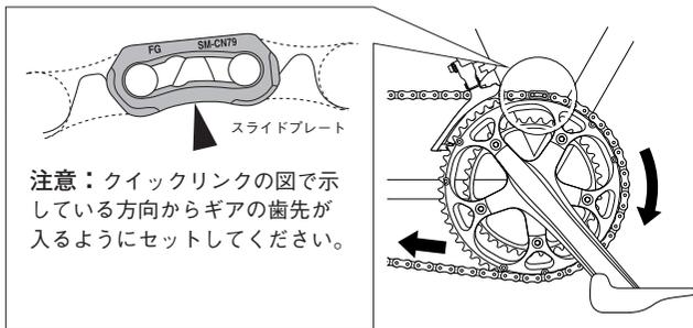
1. 両サイドともインナーリンクの状態にし、クイックリンクのフィックスプレートを差し込みます。
