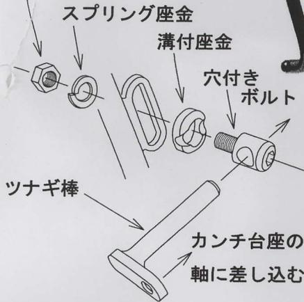
カンチブレーキを固定しているロックナットを使ってツナギ棒を固定する。(M6)
