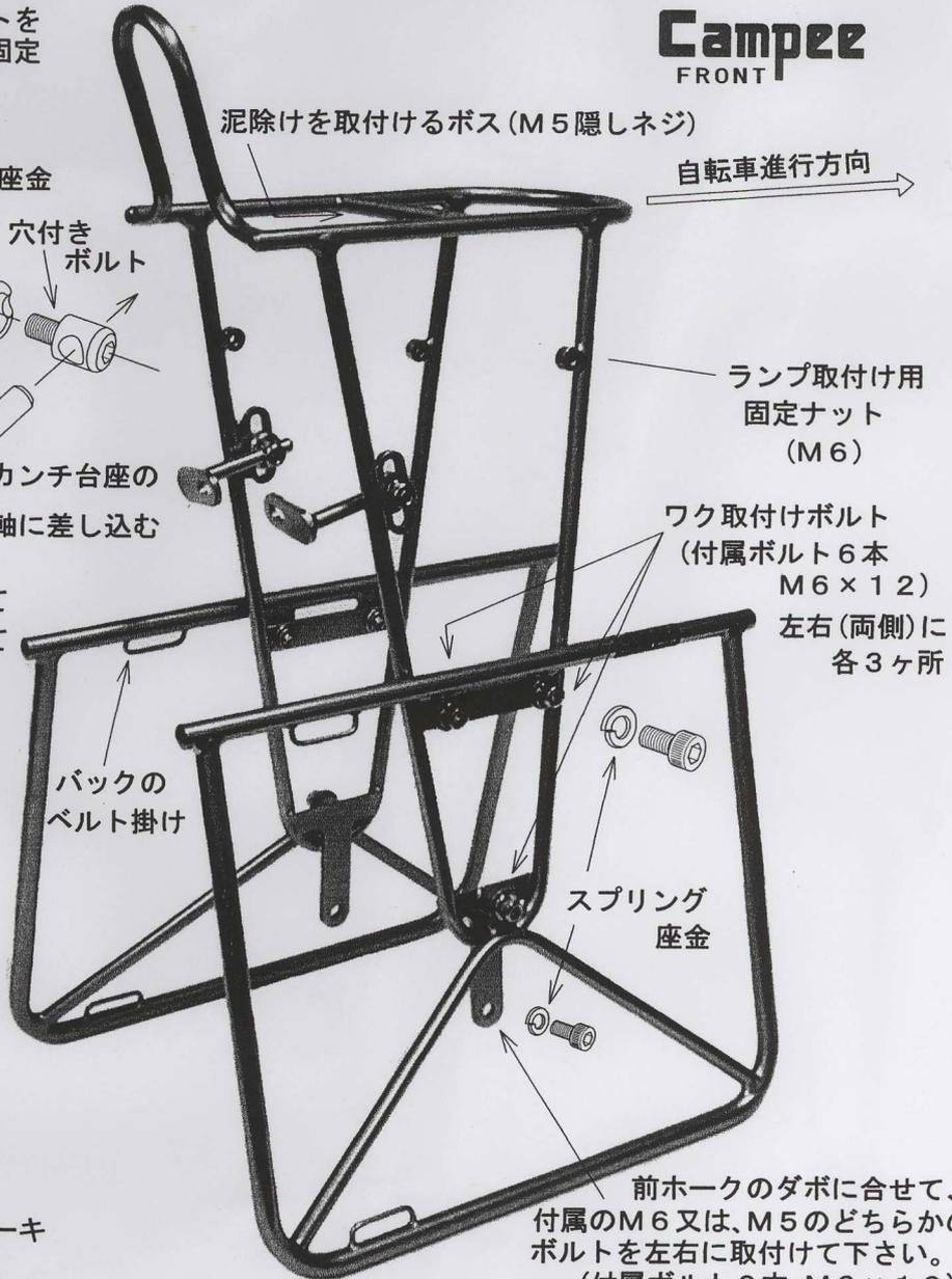
前ホークのダボに合せて、付属のM6又は、M5のどちらかのボルトを左右に取付けて下さい。(付属ボルト2本 M6×10) (付属ボルト2本 M5×10)
