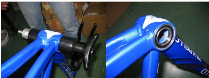
③専用ツールの小さいほうの圧入ジグでベアリングを圧入していきます。 ※斜めになっていないか注意しながら作業を進めてください。
