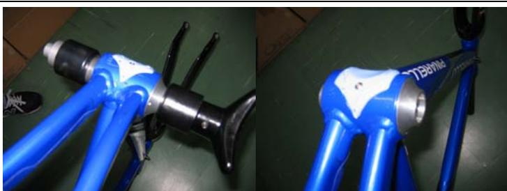
⑤専用ツールを使用し、斜めにならないように注意しながらカップを圧入します。あまり強く圧入するとベアリングに負担がかかり動きが渋くなりますので注意してください。
