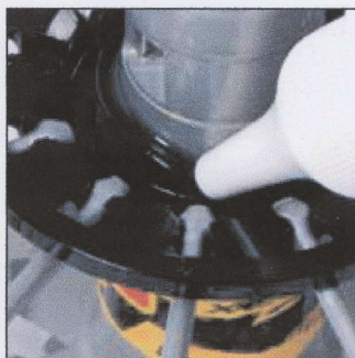
フリーホイールボディ内側の溝 2 ～ 3 本分のマヴィックミネラルオイルを差します。さらに、リップシールにも 1 滴たらしめます。
