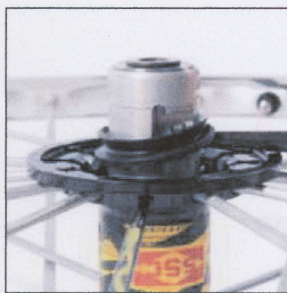
先の細い工具でリップシールを傷めないように外します。
