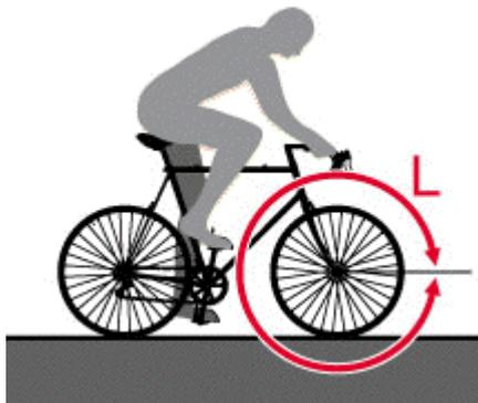
上記の表に該当タイヤがない場合は、ご自分の自転車のタイヤ周長を実測して下さい。タイヤ接地面にペンキ等で印を付けて転がし、路面についた印の間隔を測って求めてください。
