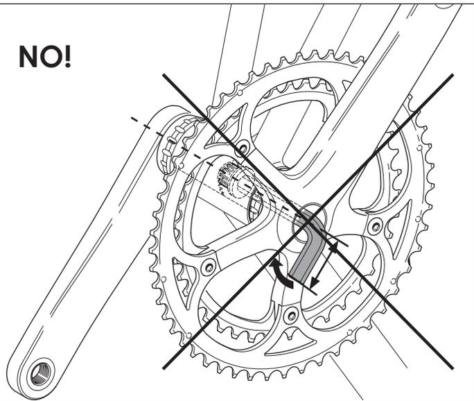
クランクセットの、二つに分割されたセミ・スピンドルは、一個のセンター・ボルトによって固定されます。スピンドルが動くのを防いだり、センター・ボルトの破損を防ぐために、センター・ボルトは最低で 42 Nm (30.97 lb-ft), 最高で 60 Nm (44.25 lb-ft) のトルクで締め付けてください。
