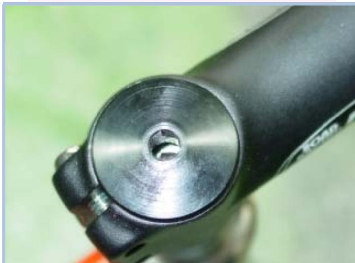
スペーサーを入れ、ステムを付けてキャップをして調整して完了。
