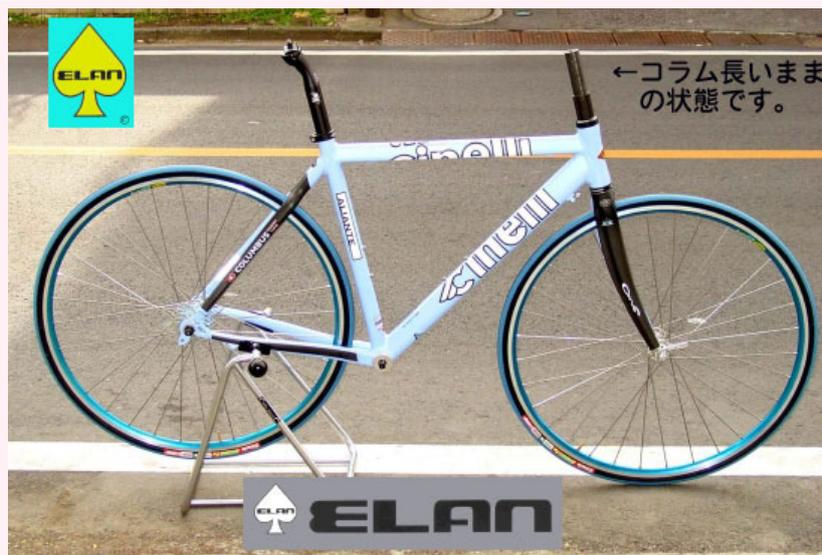
通常はこのようにカットしていない状態です。コラムをカットしてアンカーナットを打ち込みます。
